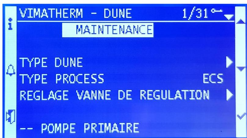
Paramétrage du type de préparateur DUNE (Instantané, Semi-Instantané, présences des sondes, ballon primaire, fonction sécurité pompes, etc.)
